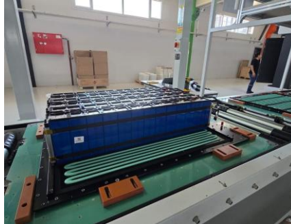
Sıvı soğutma plakalı batarya paket montaj hattı
